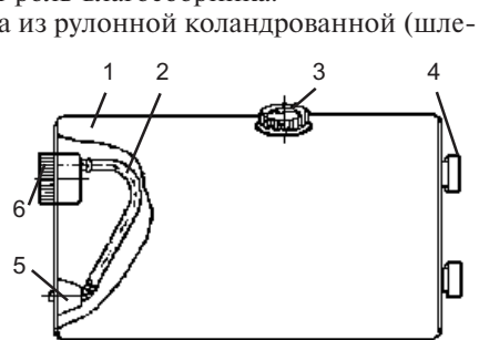
Рис. 4.13. Мешок дыхательный: 1 — мешок; 2 — трубка; 3, 5, 6 — штуцер; 4 — петля
